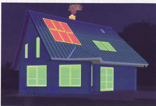
Die Wärmebildkamera zeigt unnötige Wärmeverluste (helle Flächen).
